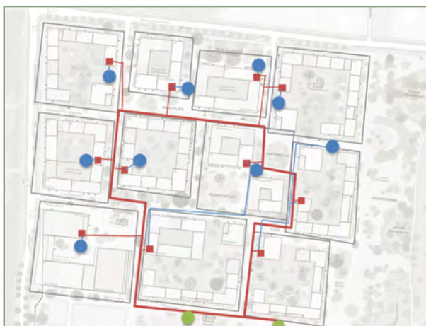
Kaltes Nahwärmenetz und Lage der Entnahme- und Injektionsbrunnen in der Eggartensiedlung
