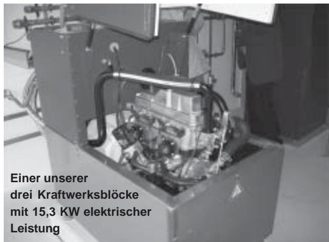
Einer unserer drei Kraftwerksblöcke mit 15,3 KW elektrischer Leistung
